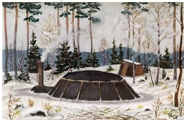
Kolning med skorstensmila. Efter bild ur Bergströms 1942
