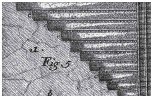
En malmgång utbruten i pallar, i det här fallet strossbrytning. Efter bild i Lindroth 1955.
